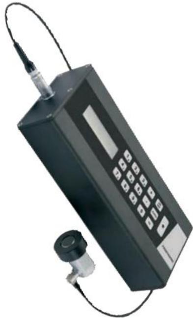
3: 箱子内有一个黑色的长方形带按键的，是测试的设置面板，面板的接口处有一个黑线，黑线尾部有个测定器，这个测定器就的用来测定活体瘦肉率的。
