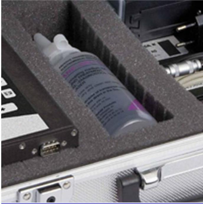
5: 我们打开箱子可以清楚的看到箱子内有一瓶液体的东西，这个液体状的物品是用于测定时涂抹在测定探头上的液体，每次测定时都要涂上一点，使用完要封口放置在安全的地方。
