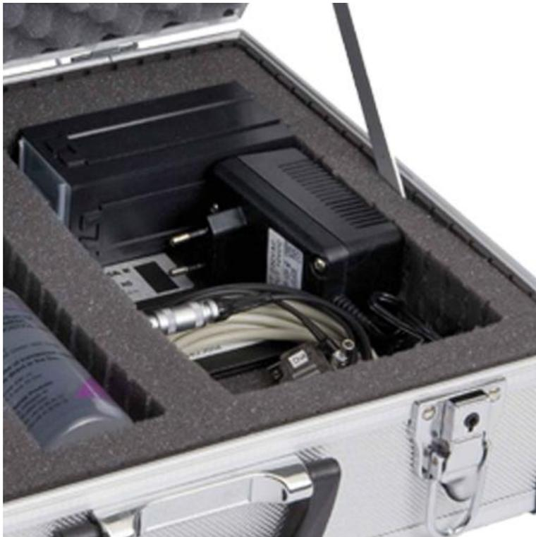
4: 箱子内有充电电池和充电器，电池安装在控制面板内，没有电时，取下电池安装在充电器上进行充电，充电时正负极要分清楚，否则充不进去电，充电的时间为 10-14 小时。
