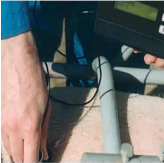
6: 测定的方法看上图，测定的方法非常的简单，取出黑色的面板，安装好电池，打开开关，将液体涂抹在测量探头上，测定探头对准猪的脊背位置停留 3 秒左右，面板上就会显示出所测定的数据，例如肥肉的深度和肥瘦的深度是多少，测定好的数据，设备会自动储存并且进行自动编号储存。
